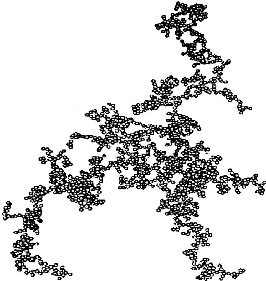
Рис. 2. Результаты расчетов ССА-модели с учетом броуновского движения, сил Ван-дер-Ваальса, стоковской скорости осаждения и магнитостатического взаимодействия.  $N = 2000$ ,  $r = 0.1$  мкм,  $c = 0.1\%$ , число магнитных частиц (на рисунке представлены черным цветом)  $0.05 N$ .
