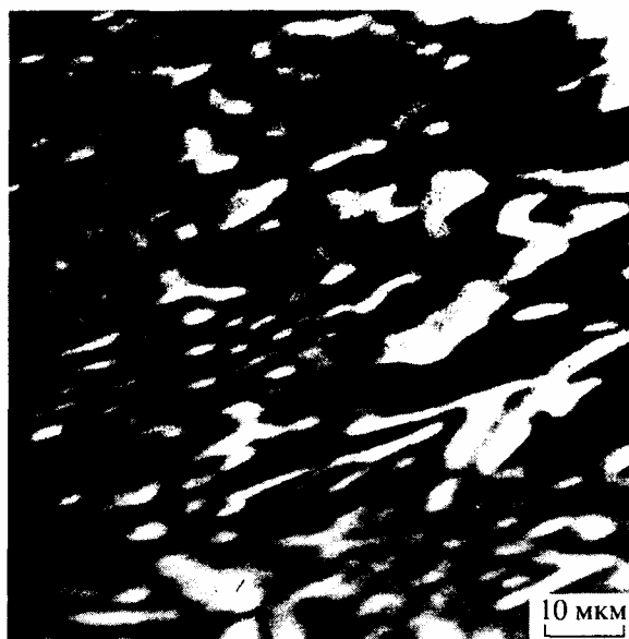
Рис. 4. Симплектитовые сростания новообразованных пикроильменита (светлые зерна) и клинопироксена при P = 25 кбар.
