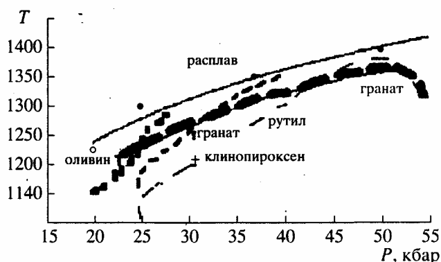
Рис. 5. PT фазовая диаграмма системы "базальт-ильменит" (II). Линиями ограничены поля кристаллизации указанных на диаграмме минералов.
