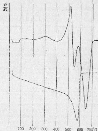
Рис. 39. Кривые ДТМА первичного (сплошная линия) и повторного (пунктир) нагревания образца гетита. Значительный эндозэффект в районе 500—650°С, вызванный потерей кристаллизационной воды, обусловил появление положительного пика кривой (575°С) и сдвиг эффекта, характеризующего магнитное превращение новообразованного магнетита до точки 650°С термомагнитогаммы. Повторный анализ показывает отсутствие в пробе ферромагнетиков с температурой Кюри выше 600°С.
